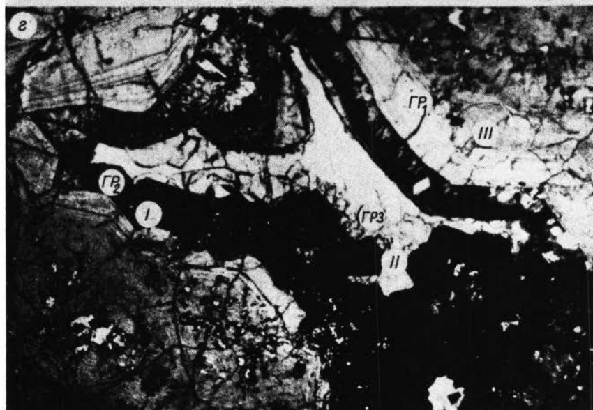
Фото 6. Оптические снимки шлифов образцов с реакционными границами между магнетитом (черное) и скарновыми минералами (светлое). I—III — участки, выбранные для изучения методами ПЭМ.
