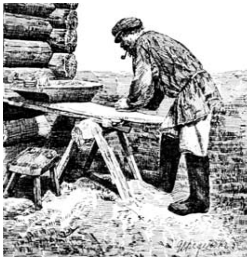
Рис. 8. Полировка белогорского мрамора ручным способом (Круковский, 1904)
