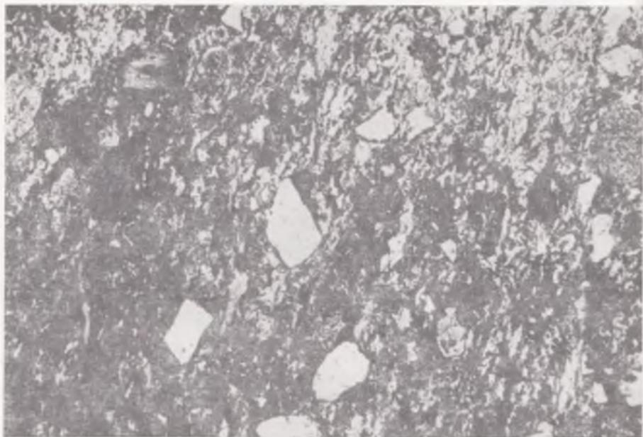
Рис. 32. Туф, обогащенный гидроокислами железа. Никולי ||,  $\times 30$ .
