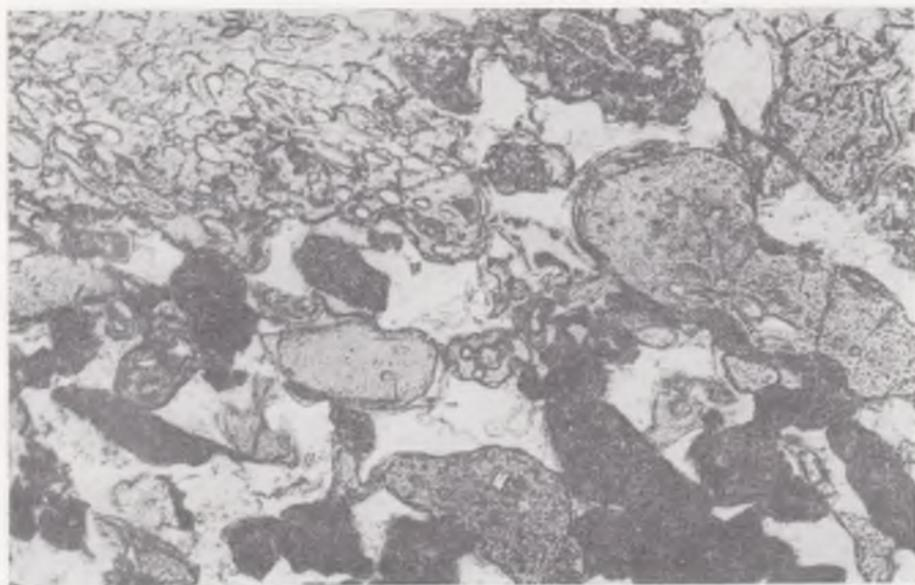
Рис. 21. Туф мелко-среднеобломочный. Видна ориентировка вытянутых обломков стекла и параллельное размещение сплюснутых пустот в обломке справа. Цемент анальцимовый. Структура литовитрокластическая. Николи ||,  $\times 50$ , скв. 14-СП, гл. 295,5 м.
