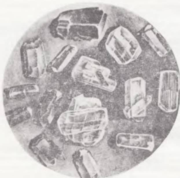
Рис. 39. Выделенные из балаклавского туфа кристаллы плагиоклаза, авгита и роговой обманки под бинокуляром,  $\times 25$ .
