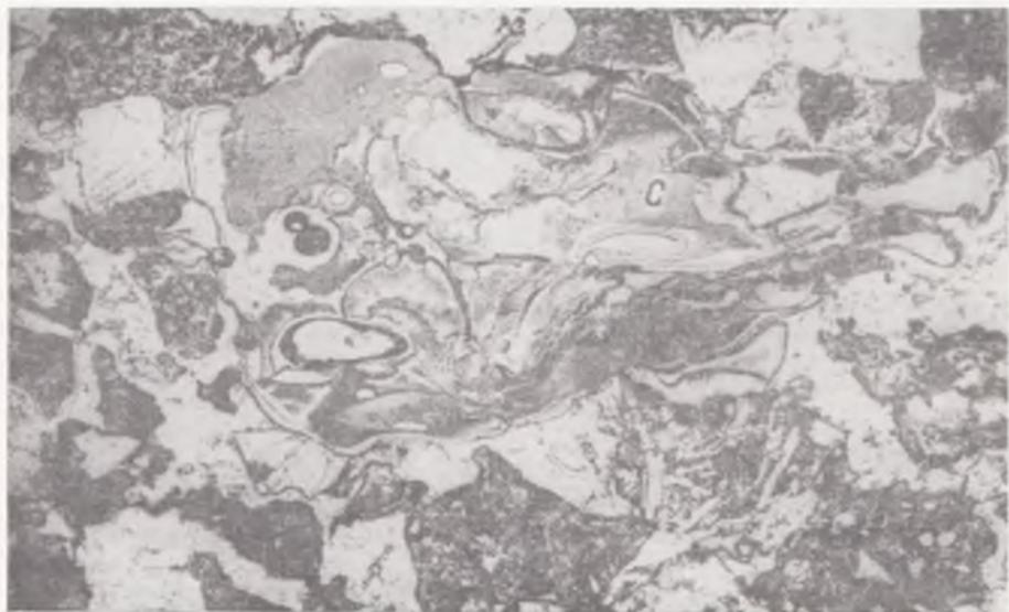
Рис. 18. Туф базальтовый среднеобломочный, литовитрокластический. Обломки сапонитизированных (с), хлоритизированных стекол и гиаобазальтов сцементированы цеолитами. В центре лапилля стекла грушевидной формы со следами закручивания и флюидално-полосчатой микротекстурой. Николи  $\parallel$ ,  $\times 50$ , скв. Новый Витков.
