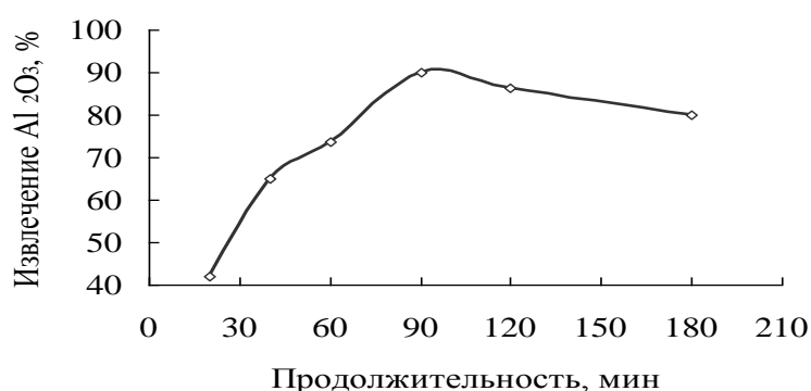
Рис. 3.4.-Зависимость извлечения глинозема от продолжительности
