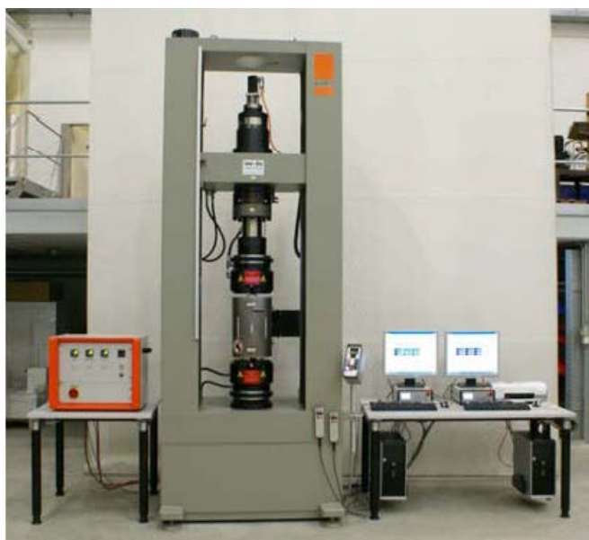
Рисунок 3.7 - Разрывная машина Walter+Baing testing machines PCS-200 (Версия EDC222)
