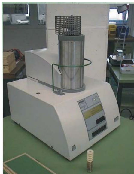
Рисунок 3.5 - Общий вид и принципиальная схема прибора синхронного термического анализа STA 449 C Jupiter.
