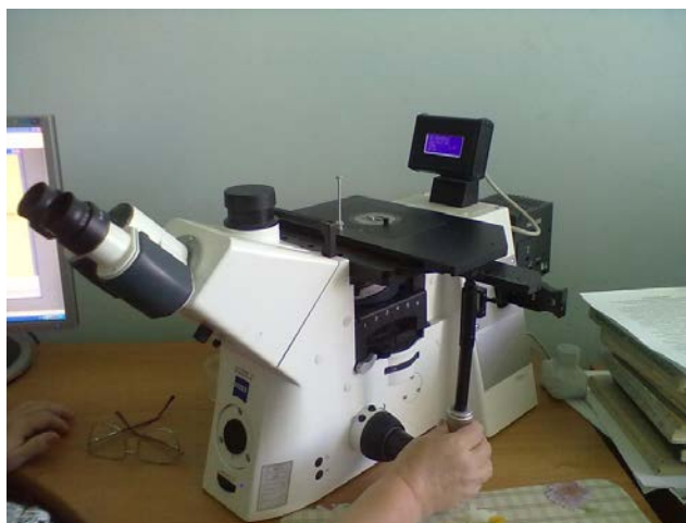
Рисунок 3.3 –Установка для микроструктурного анализа (микроскоп Axio Observer D1m)
