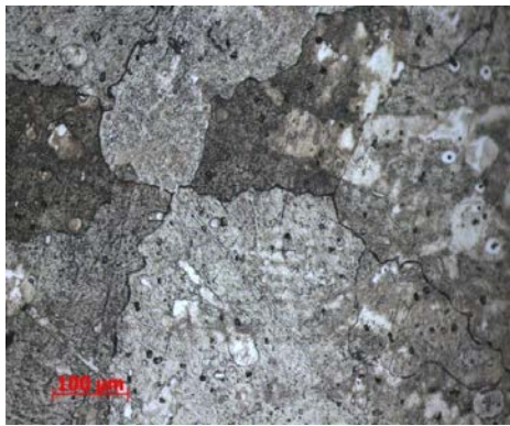
Рисунок. 4.27 – Микроструктура ПС №12 Pd-90%, Ag-9,7%, Si-0,3%
