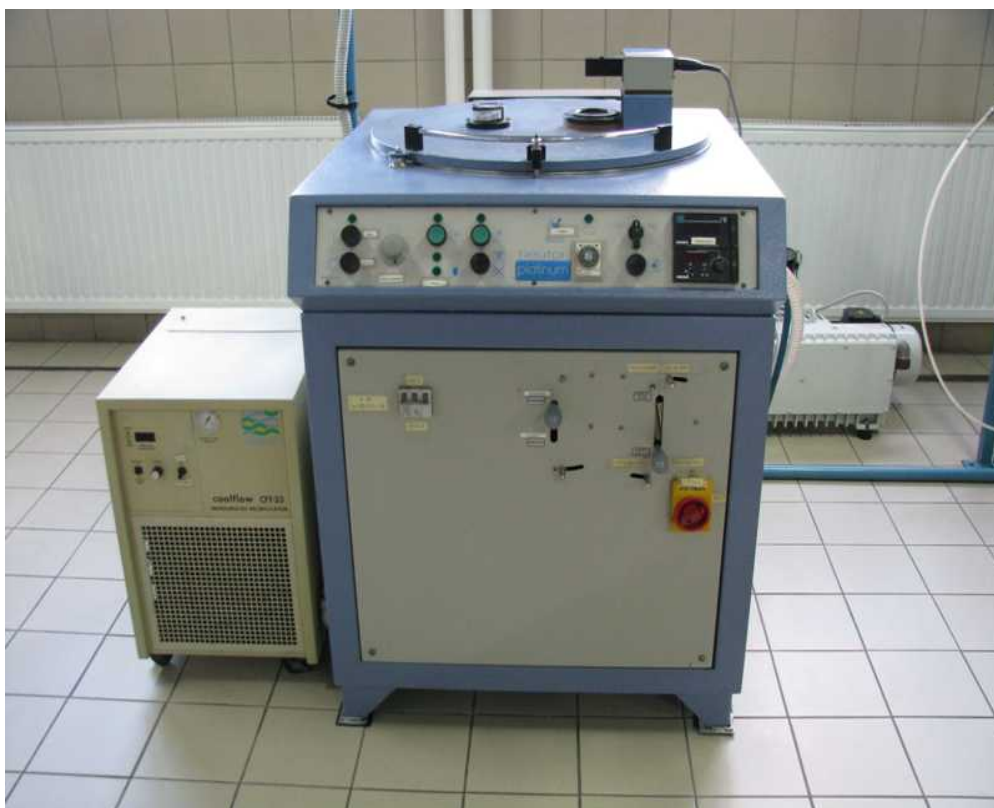
Рисунок 3.1 - Литейная машина NEUTOR DIGITAL фирмы MANFREDI: питание 220В 50 Гц, мощность 7,2 кВт, размеры 780x1060*х1090, масса 342 кг.
