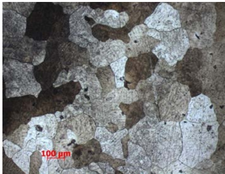
Рисунок 4.25 - Микроструктура ПС №11 Pd-95%, Ag-4,8%, Si-0,2%
