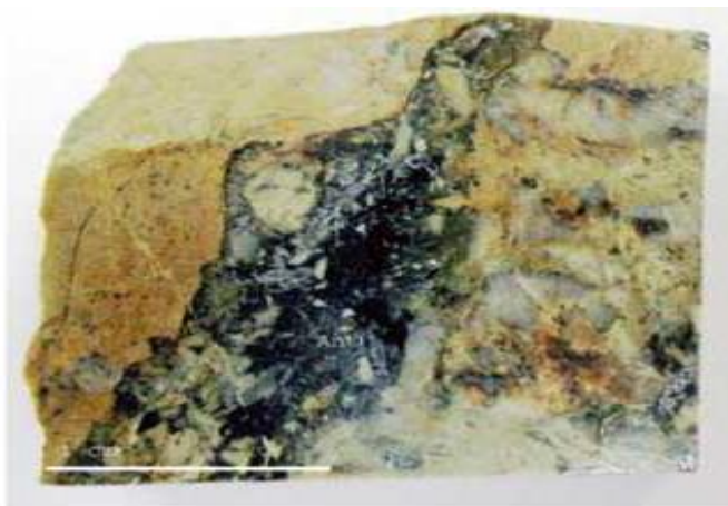
Рисунок 3.5. Мелковкрапленный антимонит в кварц-антимонитовой прожилке, аншлиф
