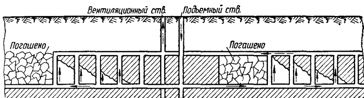
Рис. 11. Центральная схема проветривания
