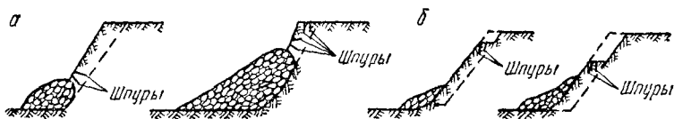
Рис. 289. Выемка уступа наклонными слоями
