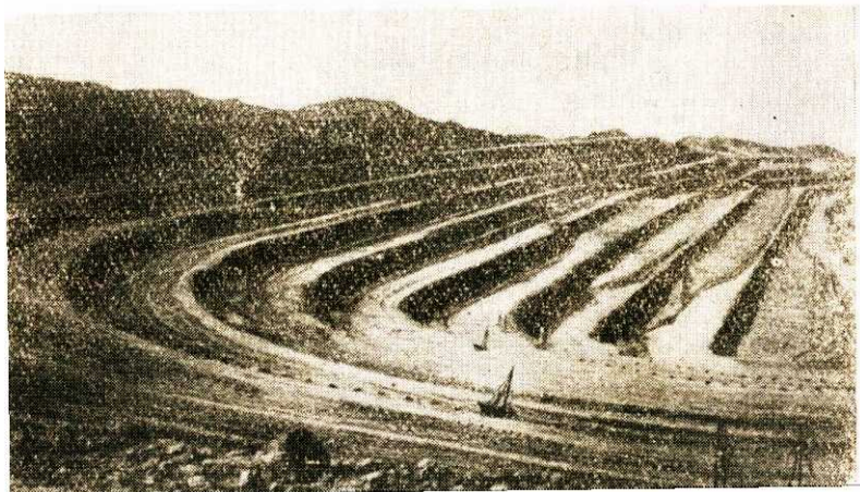
Рис. 293. Общий вид разработки с параллельным перемещением забоев
