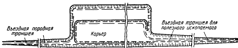
Рис. 266. Вскрытие двумя въездными траншеями
