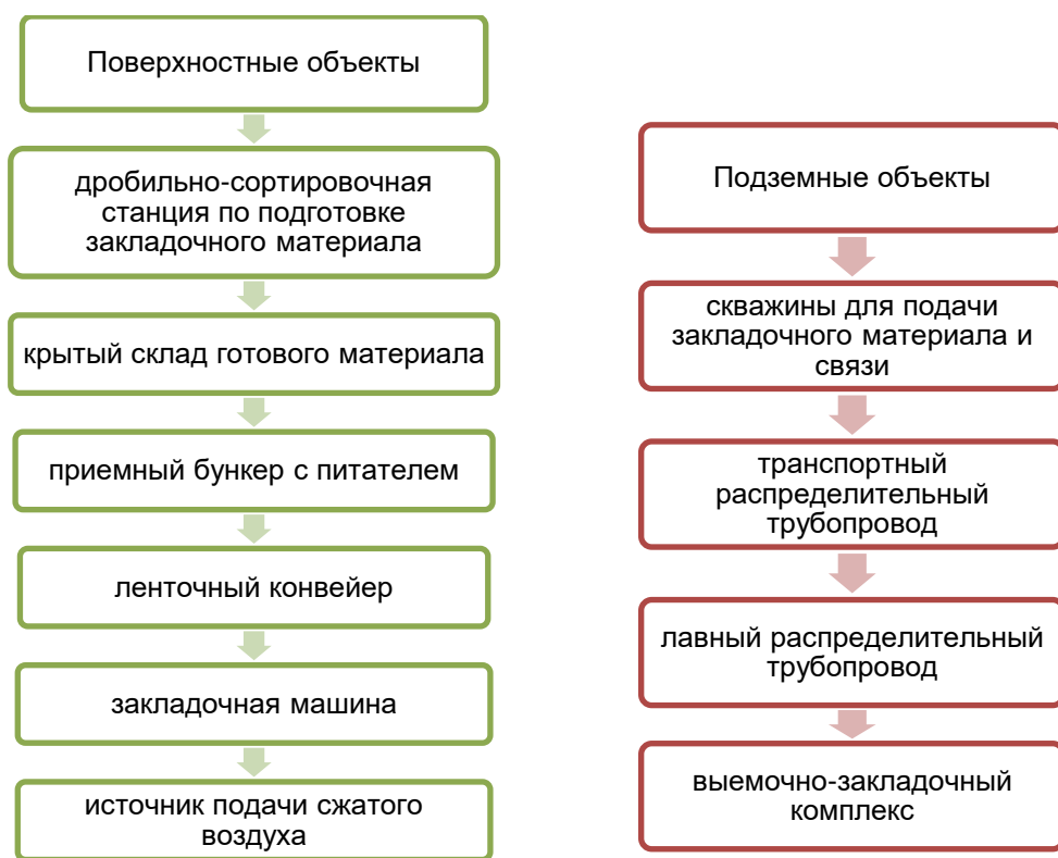
Рисунок 16 – Схема работы пневмозакладочного комплекса на шахте «Актасская»
