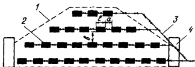
Рисунок 53 - Схема размещения удлиненных накладных зарядов по площади вруба:
