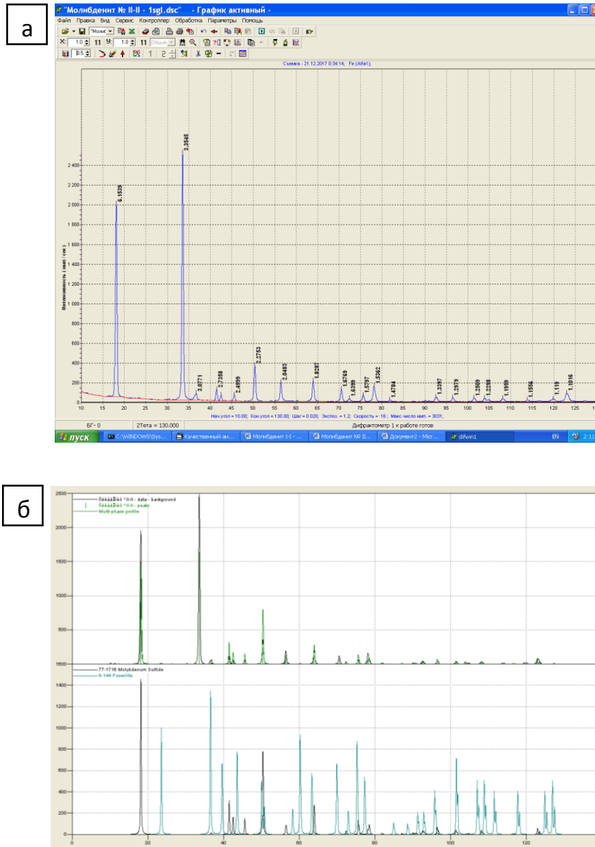
Рисунок 4.26 - Спектр образца молибденита при обработке после обработки в растворе, содержащем [Ca^{2+}] = 3,5 \cdot 10^{-3} моль/л, [H_nMoO_m] = 3 \cdot 10^{-5} моль/л, [HnCO_3] = 10^{-4} моль/л при pH = 8,5 (а) и сравнение полученного спектра образца молибденита с эталонной рентгенограммой повеллита (б)
