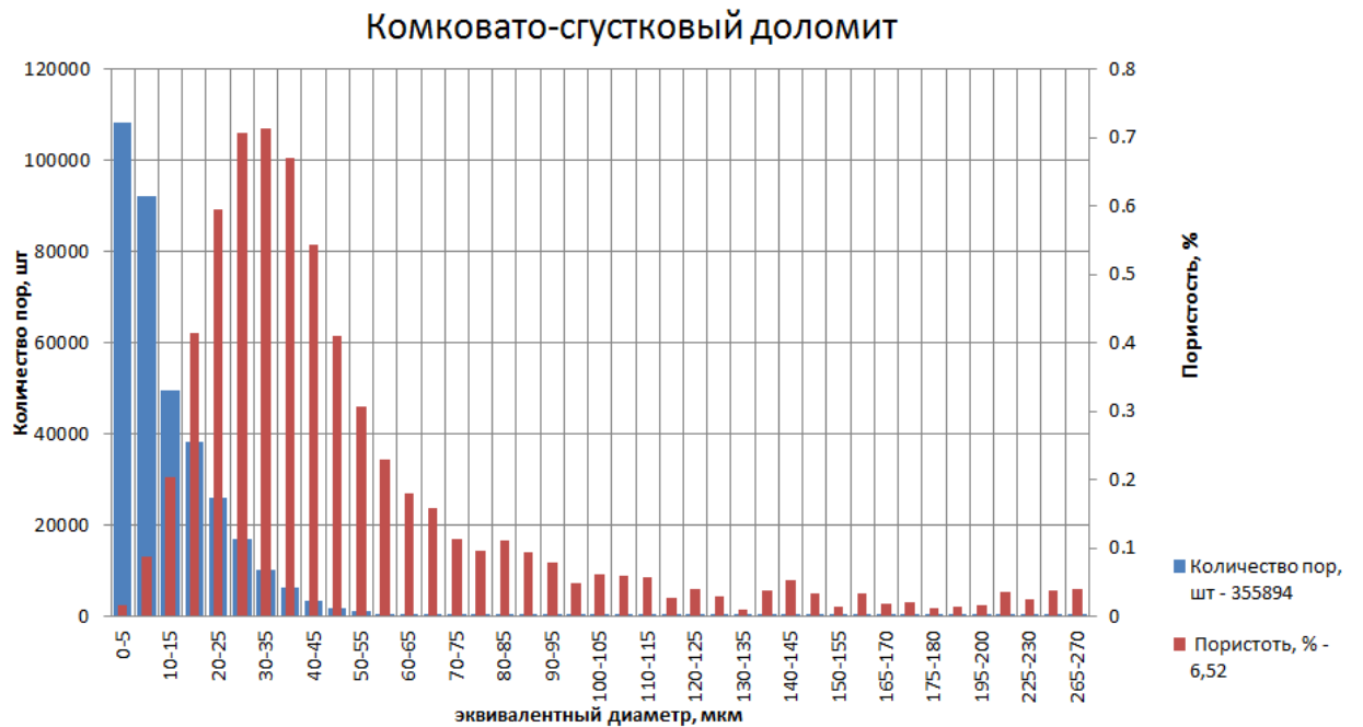
Рисунок 62. Распределение межкристаллических пустот по размеру и емкости в различных литотипах. На примере скважины 198 [кафедра литологии РГУ им. И.М. Губкина, 2011].
