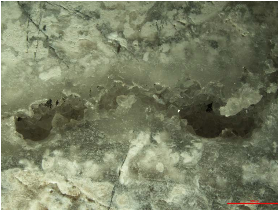
Рисунок 67. Пустоты выщелачивания в доломите слоистом интенсивно окремнелом. Скважина Юрубчено-Тохомская-272. Глубина отбора 2592,85 м. Фото с помощью стереоскопа.
