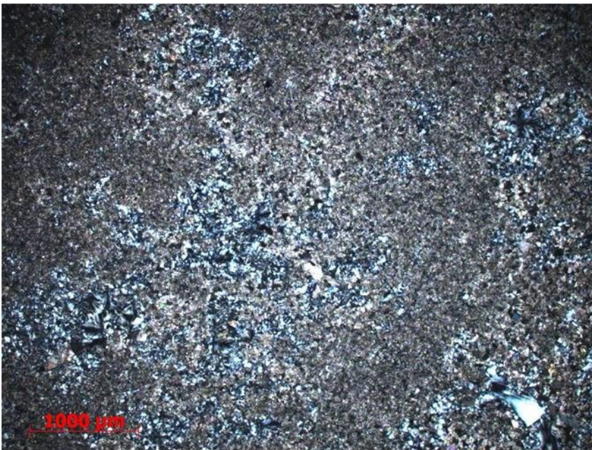
Рисунок 51. Разнокристаллический доломит. Кремнистое вещество пропитывает основную массу. Николи скрещены. Скважина Вдр-3. Глубина 2332,5 м.
