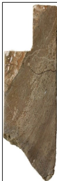
Рисунок 44. Вид затухающих микротрещин в горизонтально-слоистом доломите. Скв. 272. 2589,75 м [Кутукова, 2011].
