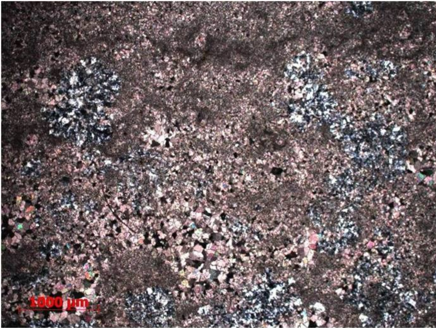
Рисунок 50. Шлиф Юр-13_21\1. Доломит строматолитовый узорчатый. Неравномерное окремнение строматолитового каркаса.
