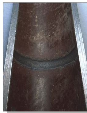
НКТ после использования абразивной гидроструи
