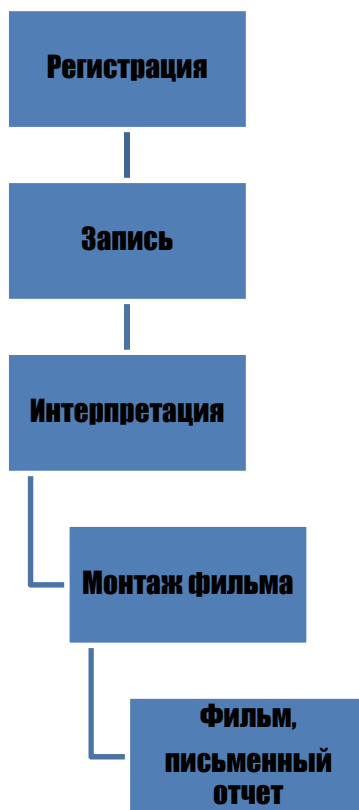
Рисунок 40 – Схема комплекса работ по обследованию скважин видеосъемкой
