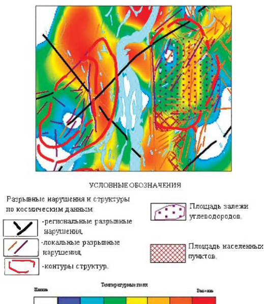
Рис. 25. Схема соотношений теплового поля, структур и разрывных нарушений, спрогнозированных по дистанционным данным, в районе Печоро-Кожвинского поднятия (справа Печоро – Кожвинское месторождение, слева открытое Западно – Печорокожвинское месторождение)
