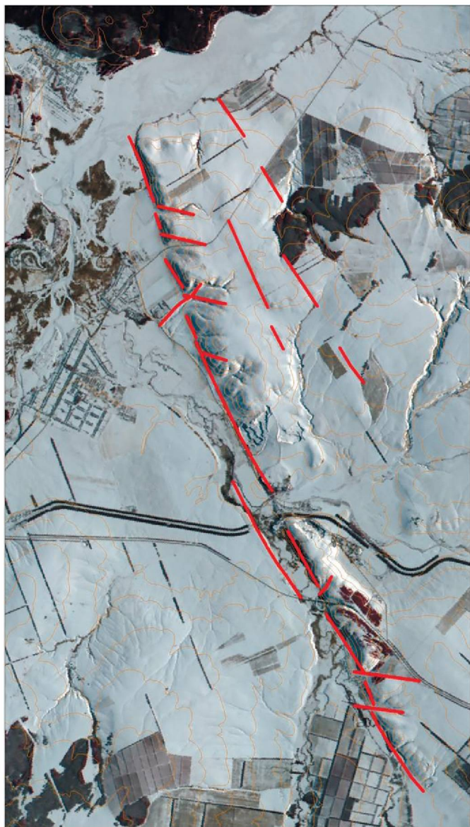
Рис. 26. Отражение на космическом снимке с КА «Терра» 29.01.04 разлома, ограничивающего с севера Жигулевский вал
