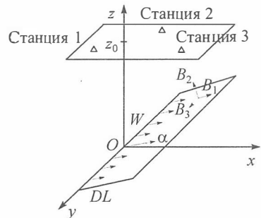
Рис. 1.7.1. Геометрические и механические параметры 2D разрыва ( W \gg DL ):
