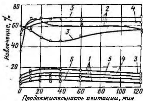
Рис. 7. Влияние агитации и температуры на результаты разделения сфалерита и пирита в цинковой флотации:
