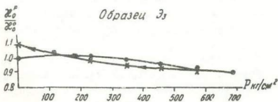
Рис. 7. Зависимости \chi_0^P / \chi_0^0 под давлением для образца Э 3
