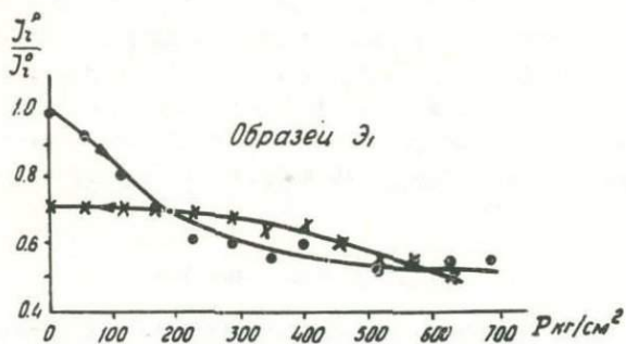
Рис. 4. Зависимости J_2^p/J_2^0 под давлением для образца Э1
