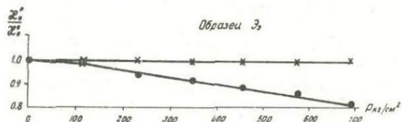
Рис. 9. Зависимости \chi_0^P / \chi_0^0 под давлением для образца Э 3
