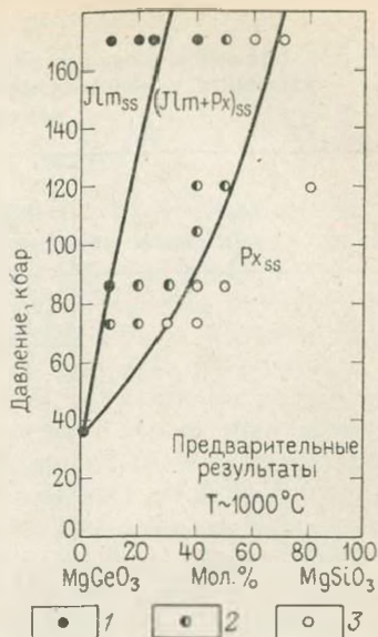
Рис. 12-2. Фазы, присутствующие в системе MgGeO_3 — MgSiO_3 при давлениях до 170 кбар и температуре около 1000°С.
