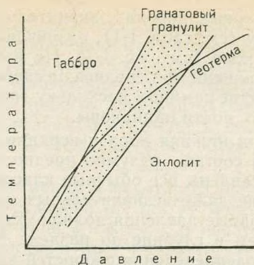
Рис. 2-12. Диаграмма пересечения геотермы с границами устойчивости габброгранатового гранулита—эклогита, иллюстрирующая увеличение эффективной ширины перехода, вызванное косым пересечением геотермы фазовыми границами
