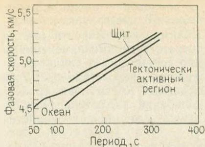
Рис. 6-1. Кривые дисперсий чистых траекторий волн Лява для океанических и тектонически активных регионов, а также для докембрических щитов.
