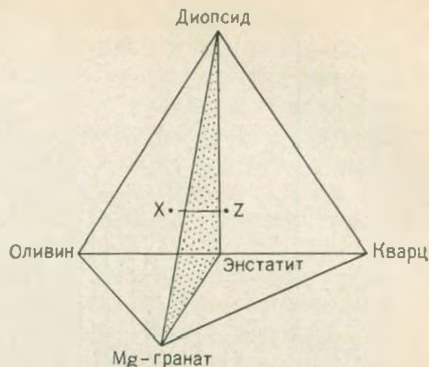
Рис. 4-5. Диаграмма, иллюстрирующая поведение при плавлении в безводной мантии при давлениях более 25 кбар.
