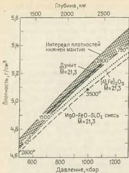
Рис. 14-5. Сравнение распределения плотностей в нижней мантии (см. текст) с плотностями некоторых модельных мантийных минералов, данные по которым получены на основании экспериментов с ударными волнами и ультразвуком.
