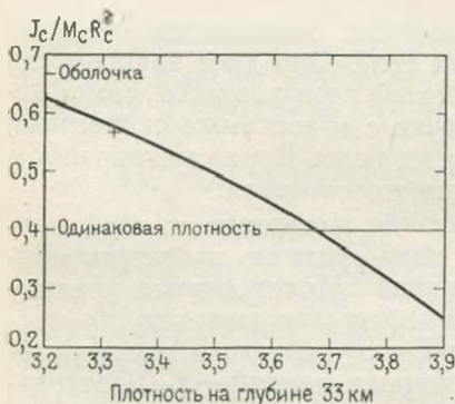
Рис. 9-2. Момент инерции центральной части ядра, как функция плотности в верхней части однородной мантии; I_c , M_c и R_c — момент инерции, масса и радиус ядра соответственно.
