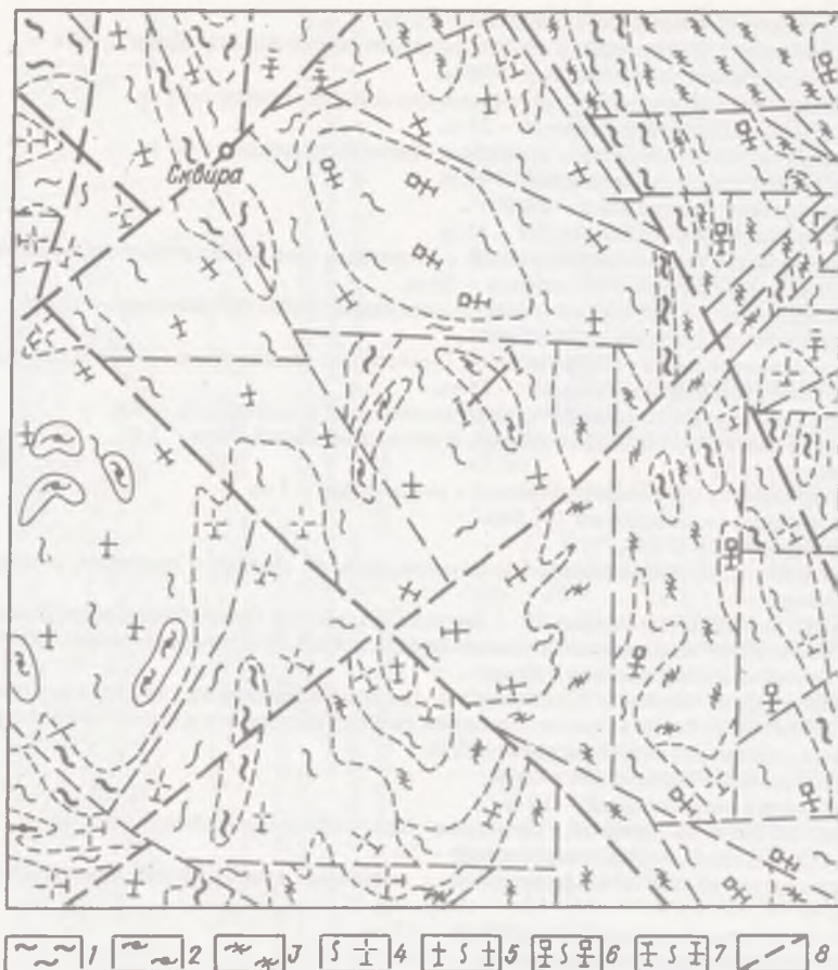
Рис. 12. Геологическое строение района Володарских магнитных аномалий. Породы: 1 – амфиболиты и гнейсы росинско-тикичской серии; 2 – амфиболиты, кристаллические сланцы, железистые кварциты и кальцифилы володарско-белоцерковской толщи; 3 – плагиомигматиты гранодиоритового состава; 4 – плагиограниты биотитовые и роговообманковые; 5 – граниты и мигматиты биотитовые и амфибол-биотитовые; 6 – гранит и мигматит порфиробластические; 7 – гранит и мигматит равностороннезернистые житомирского типа; 8 – разломы. 1-1 – Володарский опорный профиль
