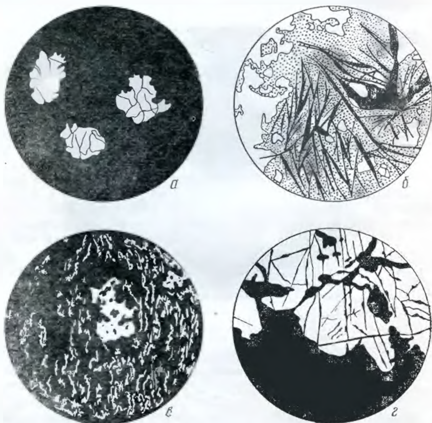
Рис. 60. Микроструктуры руд Новоберезовского месторождения. а — корродированные выделения порфиroidного пирита (белое) в тонкозернистом халькопирит-сфалерит-пирротинковом агрегате (черное); б — сфалерит-пирротиновая руда с актинолитом. Актинолит (лучистый) располагается в сфалерите (точки) и пирротине (белое). Аншл. 157, скв. 235, ув. 110; в — пиррит-халькопирит-сфалеритовая руда. Видна коррозия порфиroidного пирита (белое) сфалеритом (черное). Аншл. 274, скв. 269, ув. 38; з — взаимоотношения пирита и пирротина. Сильно трещиноватый пирит (белое) корродируется пирротинном (черное), который проникает внутрь зерен пирита по трещинам. Аншл. 263, скв. 251, ув. 28.
