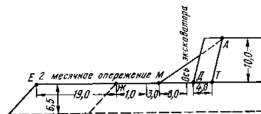
Рис. 165. Схема экскаваторной разработки вскрышного уступа с предварительным разрыхлением пород взрывом
