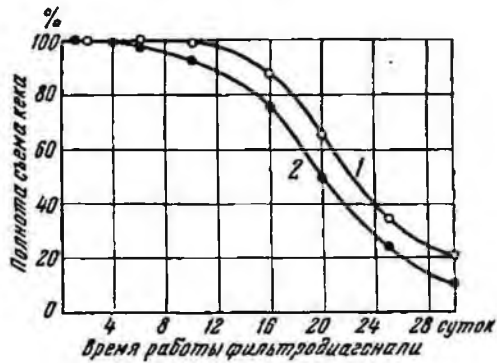
Рис. 25. Изменение полноты съема кека от срока эксплуатации фильтродиагонали: 1 — при давлении отдувки 0,2 ат; 2 — то же, 0,05 ат
