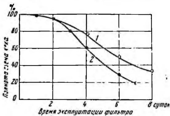
Рис. 80. Зависимость изменения полноты съема кека от режима работы мешалки: 1 — 14 качаний в минуту; 2 — 22 качания в минуту
