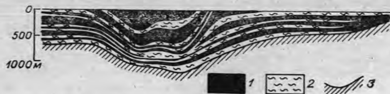
Рис. 41. Профиль через нижнепротерозойскую кремнисто-железистую формацию Криворожского бассейна (по Г. И. Каляеву [1962 г.]). 1 — железистые кварциты; 2 — сланцевые горизонты; 3 — границы с подстилающими образованиями.
