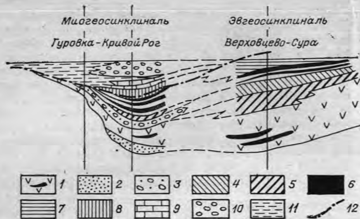
Рис. 26. Схема корреляции разрезов миогеосинклинали и эвгеосинклинали Большого Кривого Рога (по Г. И. Каляеву [1967 г.] с уточнениями).
