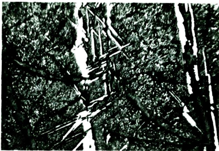
Фиг. 22. Развитие пластинок ильменита от трещинок, выполненных поздними выделениями ильменита. Полир. шлиф, протравленный HCl. Увел. 165
