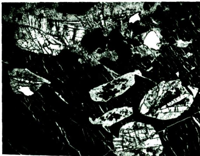
Фиг.35. Радиально-лучистые или сноповидные сростки кристаллов тремолита, развивающиеся по измененным первичным силикатам, содержавшимся в руде. Прозр.шлиф. Увел.10, без анализатора
