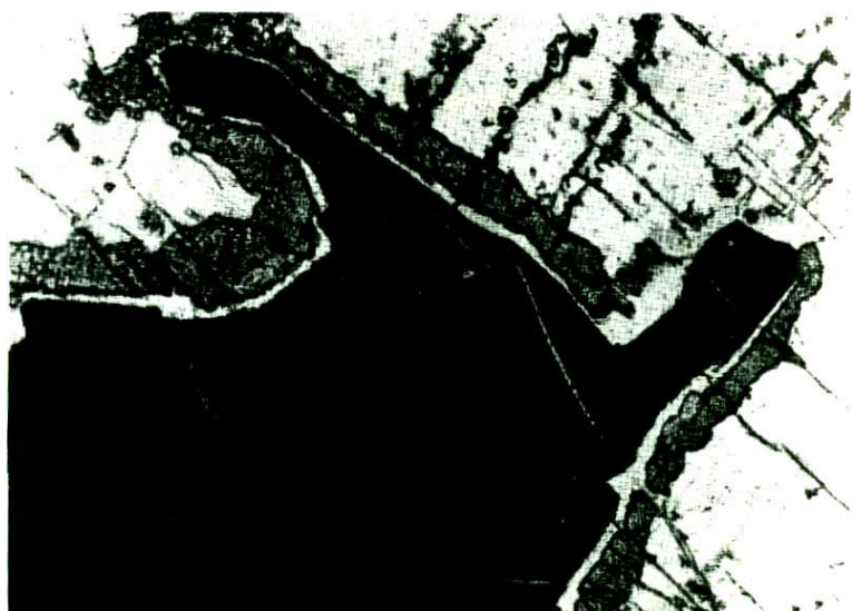
Фиг.52. Каемка тонкозернистого граната на контакте рудных зерен с плагиоклазом. Увел. 46, без анализатора
