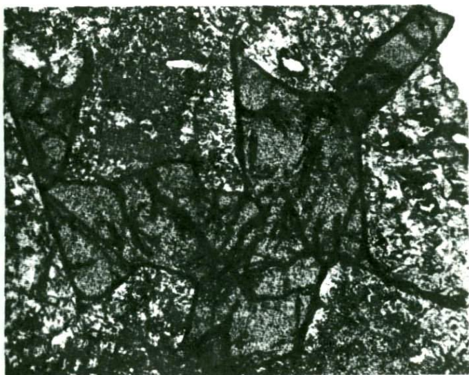
Фиг. 9. Ксеноморфное выделение титанита в измененном габбро. Увел.30, без анализатора
