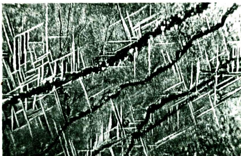
Фиг.18. Развитие пластинок ильменита от трещинок. Полир.шлиф, протравленный HCl. Увел,160
