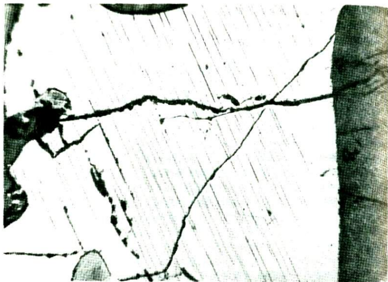
Фиг.45. Распределение пластинок магнетита в центральной части зерна ильменита. Полир. шлиф, протравленный HCl. Увел.90
