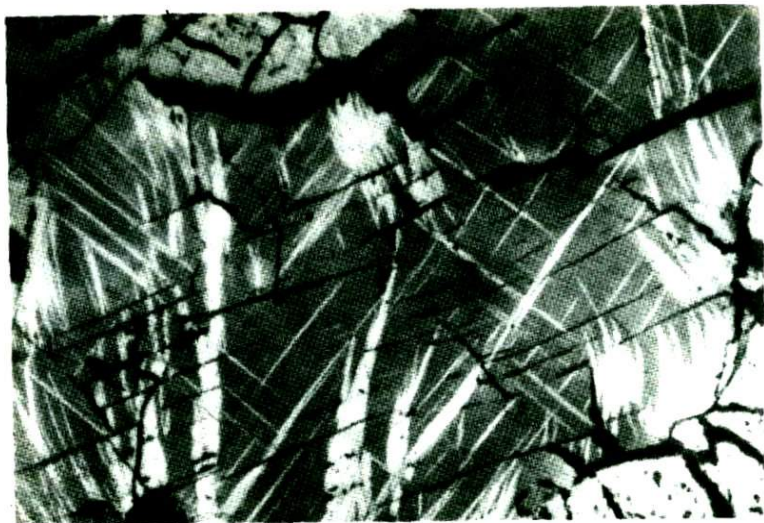
Фиг.47. Сложный тип двойникования в ильмените, представленный тонкими пластинками ильменита, образующими решетчатую структуру, и более грубыми перистыми двойниками, окаймляющими с краев зерна ильменита. Увел.40, николи скрещены
