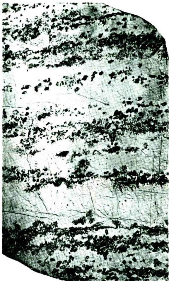
Фиг.15. Полосчатая титаномагнетитовая руда. Светло-серое - титаномагнетит; темно-серое - нерудные минералы. Natur. вел.
