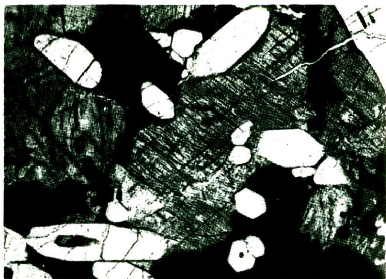
Фиг. 56. Кристаллы апатита, приуроченные к рудным минералам и пироксену в мелкозернистом габбро. Увел. 20, без анализатора
