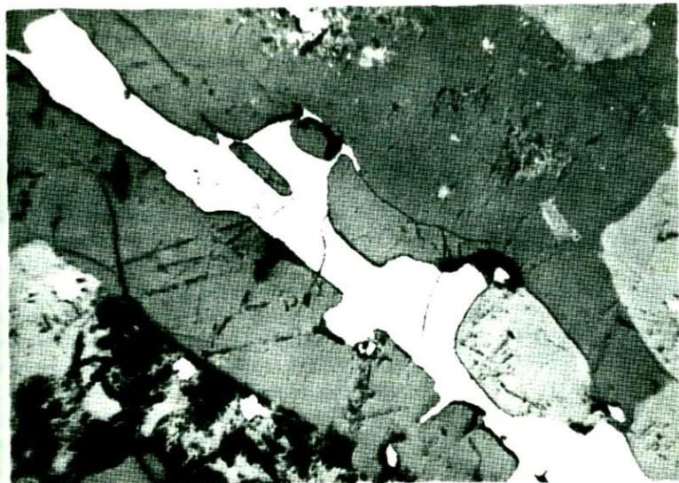
Фиг.43. Характер выделения ильменита в мелкозернистом трахитоидном габбро. Полир. шлиф. Увел. 25
