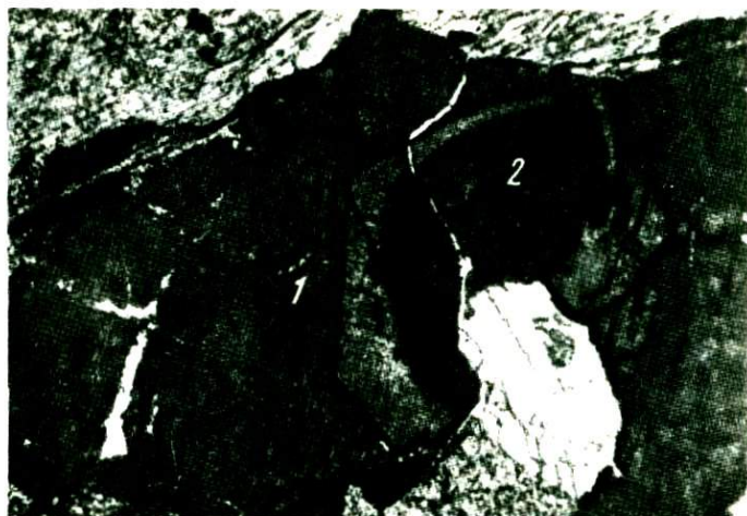
Фиг.10. Титаномагнетит (1) замещается лейкоксенитом; ильменит (2) частично замещается титанитом, при этом отчетливо выявляется характер поверхности срастания зерен титаномагнетита и ильменита. Увел.30, без анализатора
