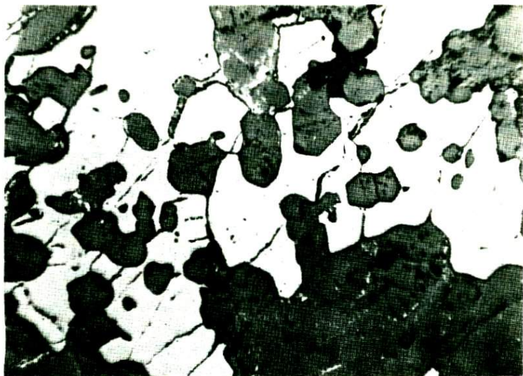
Фиг.49. Срастание зерен ильменита (белое) и кристаллов апатита (серое); западная зона Копанского массива. Полир. шлиф. Увел. 40
