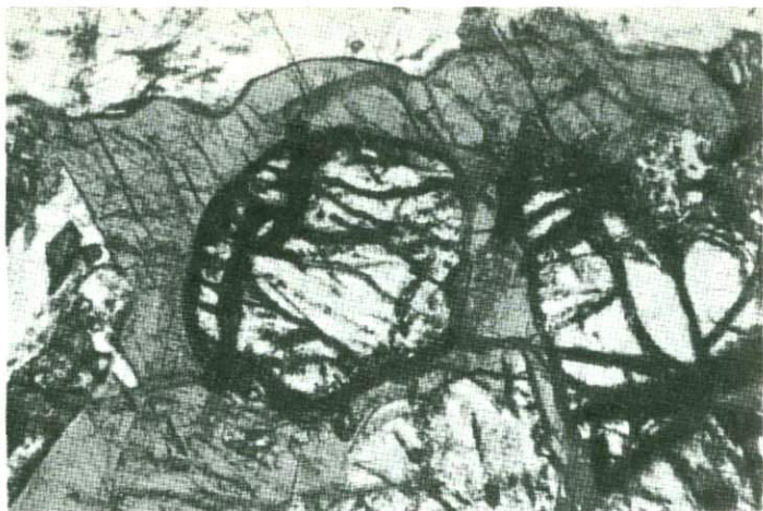
Фиг.6. Бурая роговая обманка (керсутит) нарастает на зерна оли- вина. Увел.46, без анализатора
