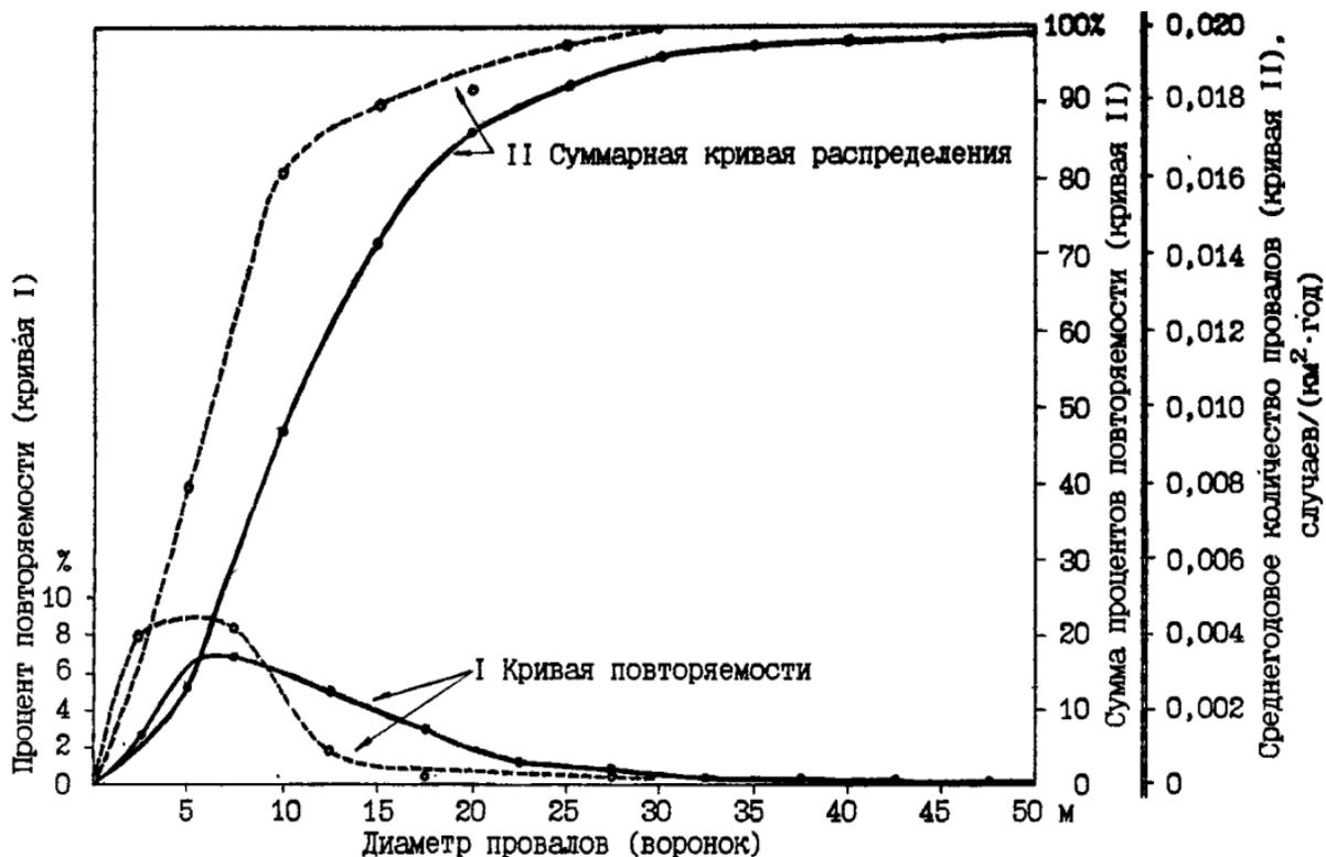
Рис.6. График распределения карстовых провалов и воронок по величине их диаметров в районе г.Дзержинска /18/
