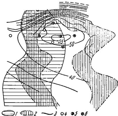
Рис. 28. Схематическая карта микробиологической грунтовой съемки, проводившейся в 1943 г. на разведочной площади в районе Среднего Поволжья, в сопоставлении с данными последующего бурения (по Г. А. Могилевскому):
