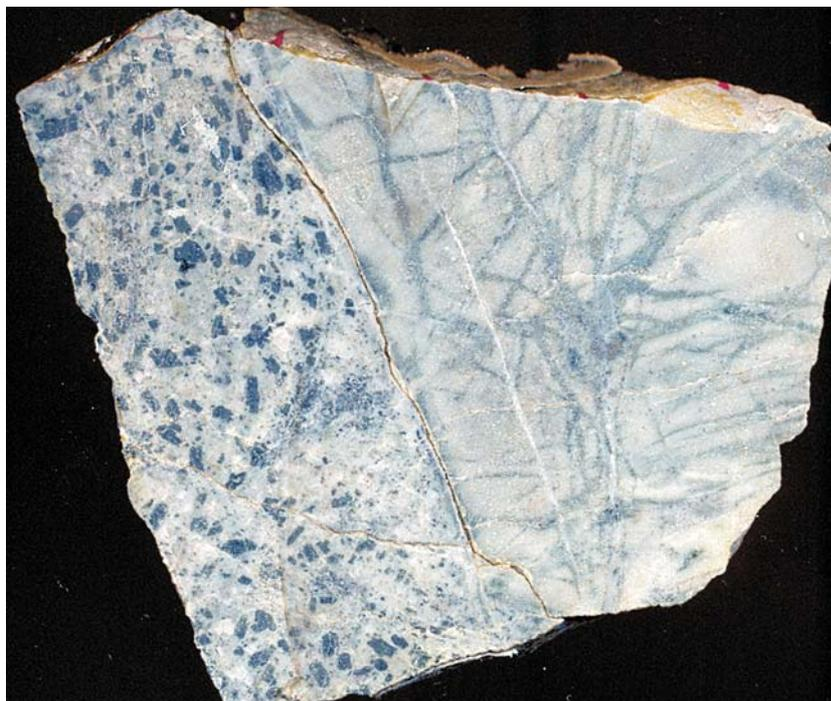
Резкий контакт диоритового порфирита с зоной его березитизации и контроль «тонкой» сульфидной золотосодержащей минерализации различными ориентированными трещинами. Юбилейное золоторудное месторождение (Южный Урал). Длина образца 10 см
