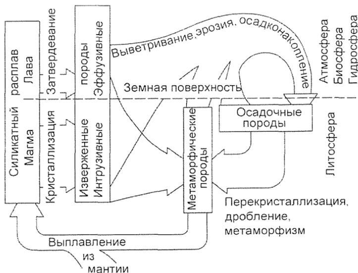
Рис. Цикл образования пород (из работы К. Гиллена, 1984)
