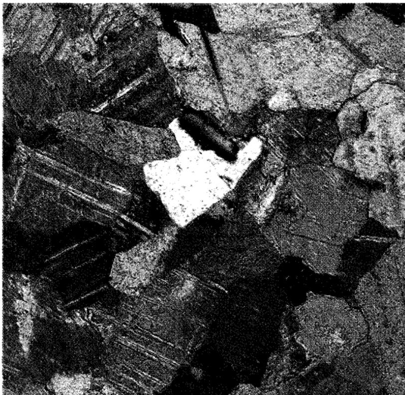
Рис. 3.6. Николи «+». Мрамор. Гранобластовая структура, образованная изометричными зёрнами кальцита с извилистыми границами
