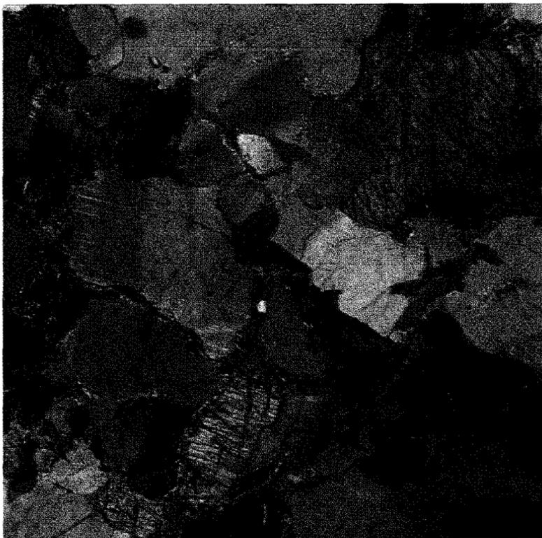
Рис. 3.36. Николи «+». Гиперстен-плаггиоклазовый гнейс. В составе породы присутствует коричневато-оранжевый биотит, типичный для гранулитовой фации
