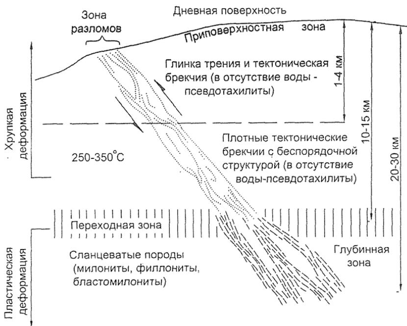
Рис. 2.1. Схема строения зоны разлома, иллюстрирующая изменение характера деформаций и типов пород с глубиной (из работы К. Гиллена, 1984)
