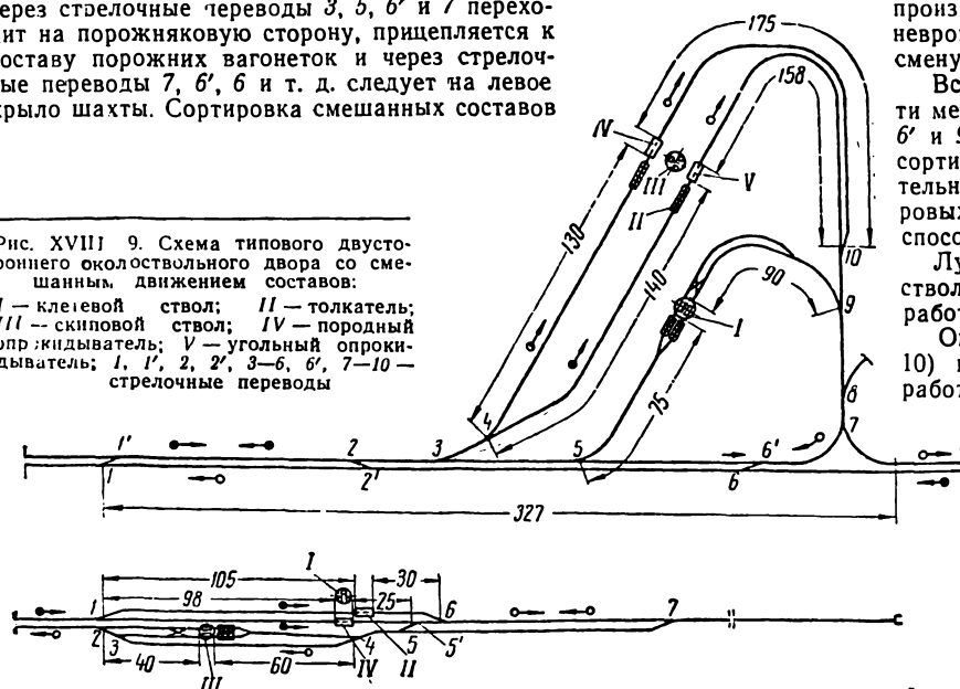
Рис. XVIII. 10. Схема одностороннего околоствольного двора с одной многопутевой выработкой для вагонеток с разгрузкой через дно:
