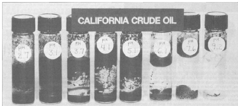
Рис. 6.5. «Бутылочный тест» для природной нефти California
