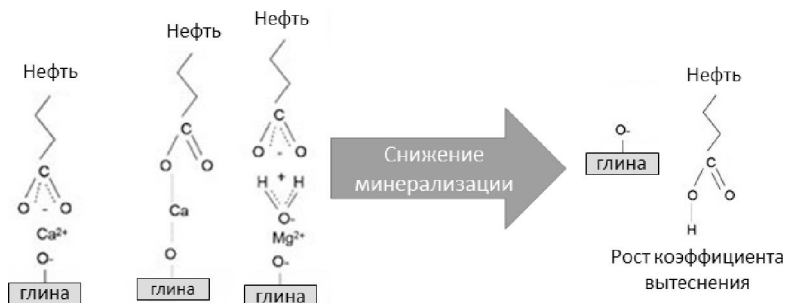
Рис. 8.9. Механизм увеличения нефтевытеснения за счет гидрофилизации поверхности породы
