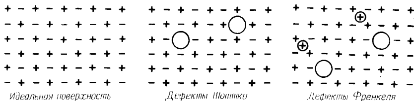
Рис. 1.9. Модель поверхности ионного кристалла 1 – 1 в идеальном состоянии содержащей дефекты Шоттки и Френкеля (вид сверху)
