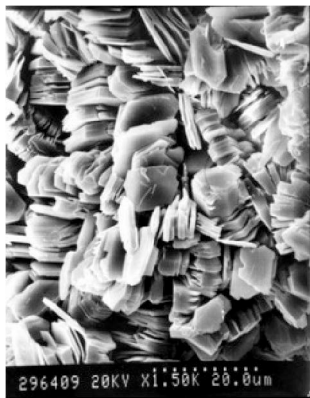
Рис. 5.9. Структура порового пространства и микростроение каолинита (РЭМ-изображение)
