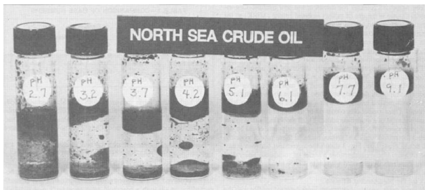
Рис. 6.4. «Бутылочный тест» для природной нефти North Sea
