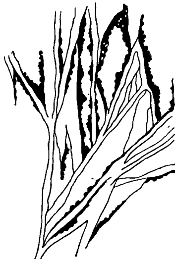
Рис. 216. Фрагмент алмазно-пестельчатой текстуры лимонита по галениту. Увел. 4
