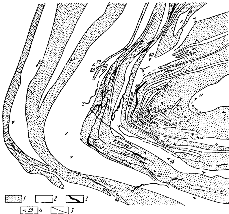
Рис. 324. Схема геологического строения золоторудного месторождения «Жданное», жилы которого сосредоточены у перегиба антиклинальной складки. По С. Гаврикову и В. Жаровой
