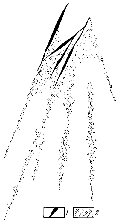
Рис. 241. Рудные струи делювиальной россыпи (в плане)
