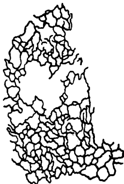
Рис. 196. Фрагмент губчатой текстуры лимонита по сфалериту. Увел. 6
