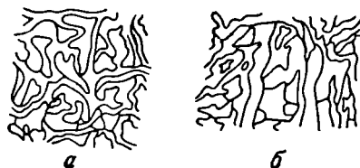
Рис. 199. Контурная ящичная текстура лимонита, образовавшегося из тетраэдрита. Увел. 7. По Р. Бланчерду и П. Босуэллу а — лимонит из Жиллеспай, Новая Мексика; б — лимонит из Уорлдс Файр, Аризона
