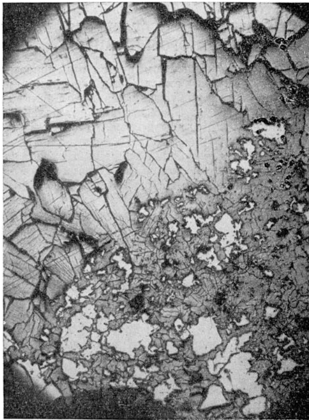
Рис. 204. Месторождение Блява на Урале. Зона вторичного обогащения. Замещение пирита (белое) халькозином (серое). В верхней части крупнозернистый халькозин выполняет трещину, в нижней части он представляет собой мелкозернистый агрегат, образовавшийся на месте пирита и заключающий остатки его. Увел. 46.
