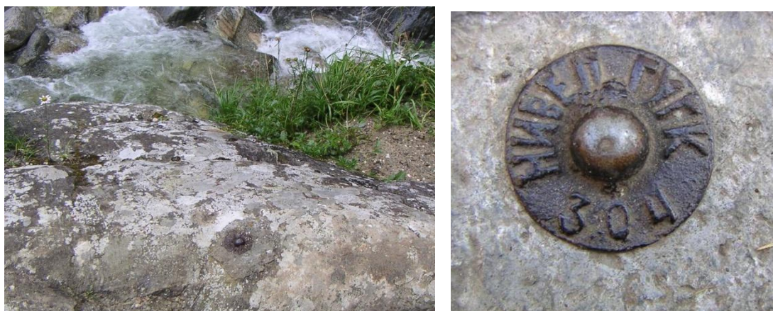
Рис. 7.25. Фото государственного грунтового репера, установленного в горной местности
