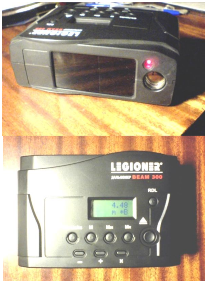
Рис. 3.8. Дальномер, снабженный двумя лазерными излучателями (дальность измерения до 270 м)
