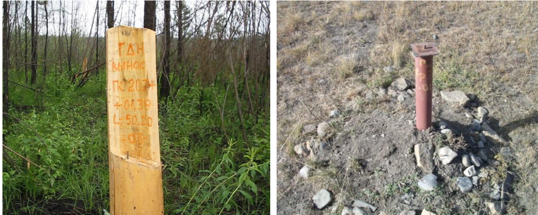
Рис. 7.22. Фото грунтового репера ГДН (установленный институтом ГипроДорНИИ)
