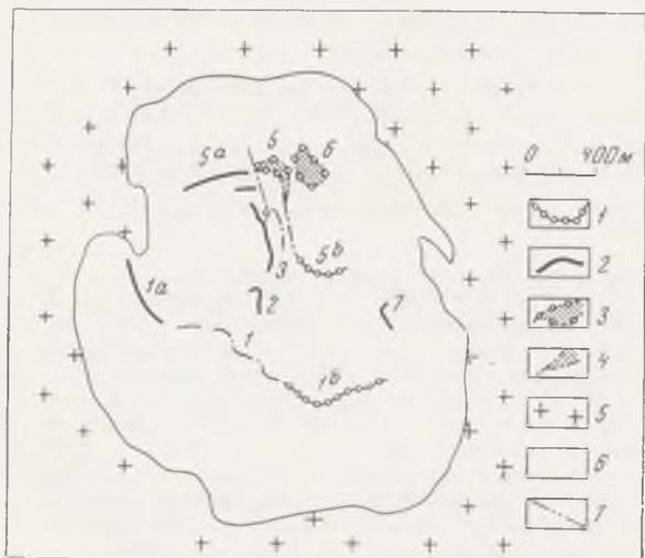
Фиг. 54. Схема геологического строения пегматитового пучка с зональным расположением микроклин-альбитовых и альбитовых пегматитов
