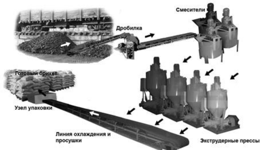
Рис. 2.4. Технологическая схема производства брикетов
