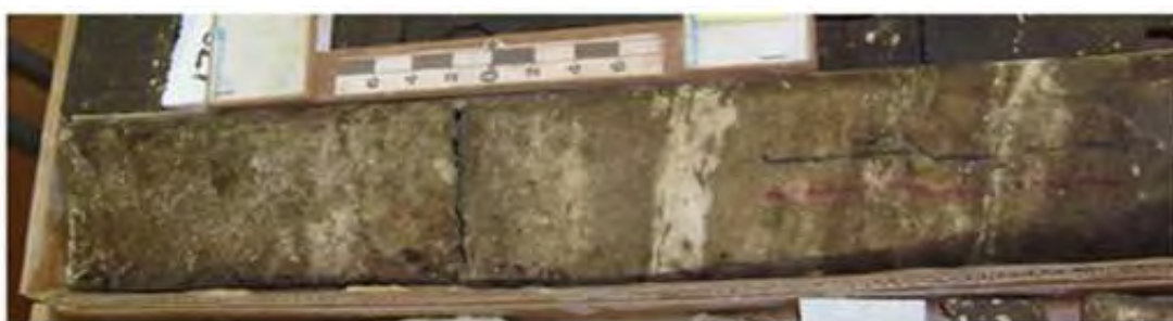
Рисунок 3.3 – Типизация трещин по керну скважины №2 ОЦ [24]:
