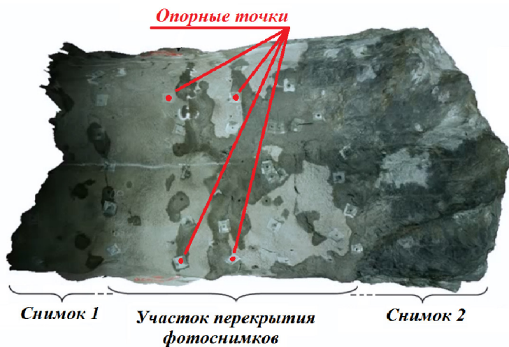
Рис. 5.42. Опорные точки на стереомодели
