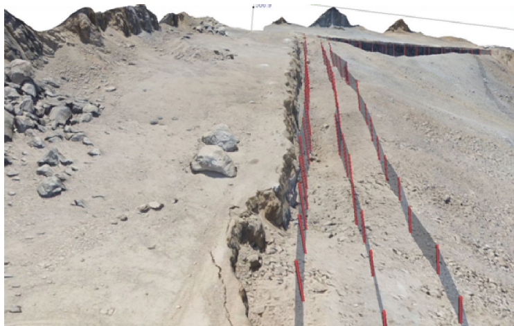
Рис. 5.16. 3D-модель участка горных работ после взрыва
