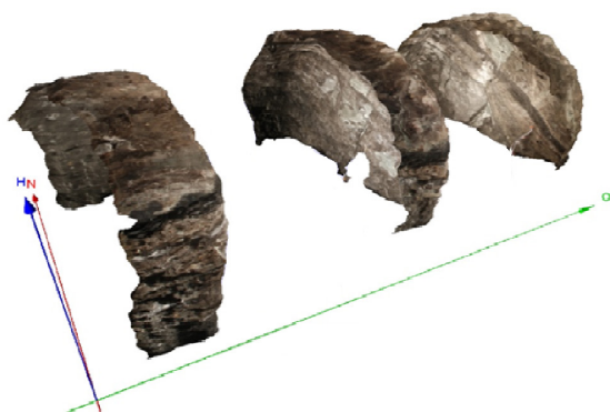
Рис. 5.4. Последовательность проходки горной выработки
