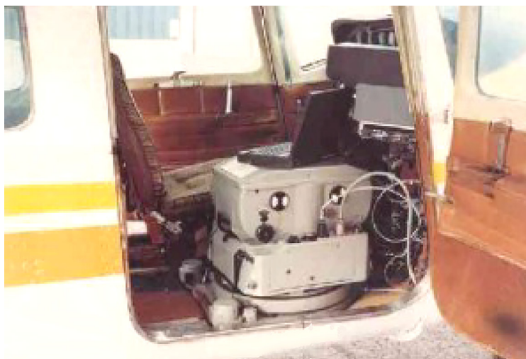
Рис. 3.2. Аэрофотокамера Carl Zeiss RMK 15/23, установленная в самолёте
