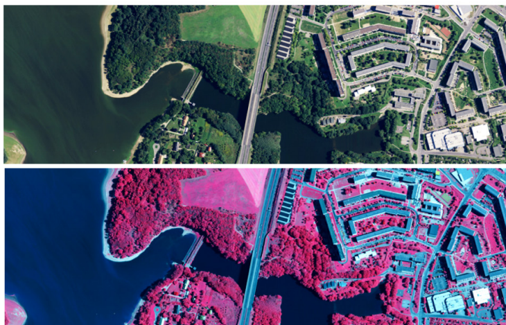
Рис. 3.19. Пример RGB - и NIR -изображений при спектрональной съёмке
