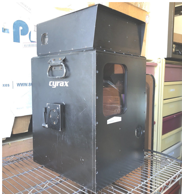
Рис. 3.4. Первый наземный лазерный сканер Cyra-2400 , 1998 г.
