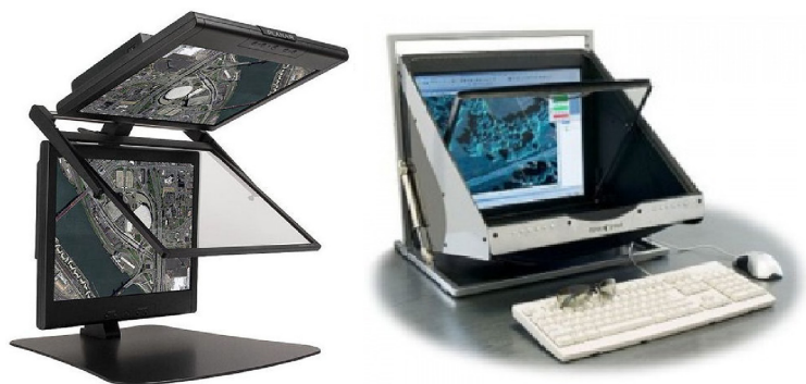
Рис. 4.16. Зеркальные стереомониторы Planar и StereoPixel
