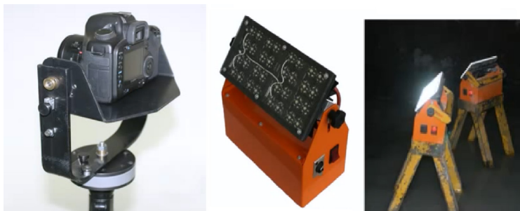
Рис. 5.40. Фотограмметрическое оборудование для подземных съёмок
