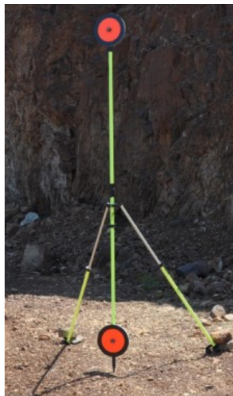
Рис. 5.5. Комплект оборудования и установка опорных марок
