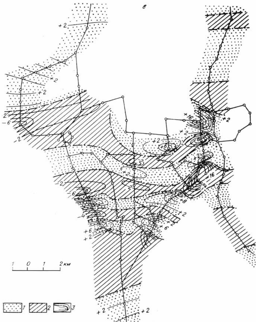
Рис. 6.10. Схемы накопленной деформации изгиба земной поверхности по субмеридиональным профилям на Алма-Атинском геодинамическом полигоне. Периоды, годы: а — 1968—1971, б — 1968—1973, в — 1968—1975; 1 — зоны положительных и 2 — отрицательных значений изгиба; 3 — изолинии равных значений (в 10^{-6} ).
