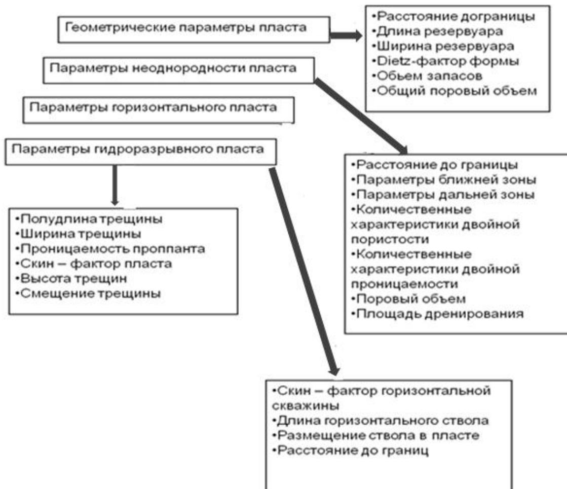
Рис. 11.3. Гидродинамические модели системы скважина-пласт в базе данных «Гидра-Тест-М»
