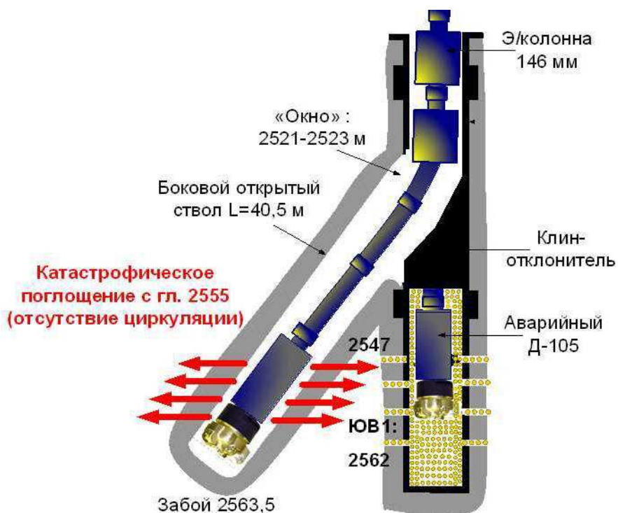
Рисунок 4 – Обход аварийного участка зарезкой бокового ствола с использованием забойного двигателя со шламоуловителями (скважина 203 куст 3 Аригольского месторождения)
