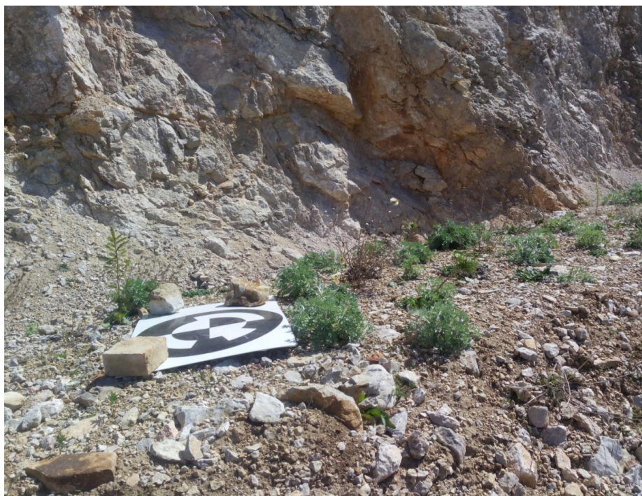
Рисунок 4.4 – Точка съемочного обоснования, расположенной на карьере Прег
