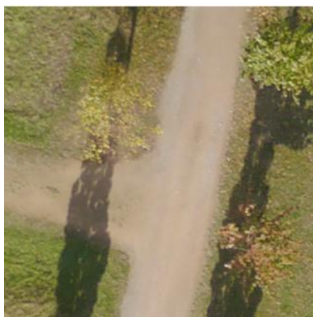
Рисунок 4.9 – Фрагмент ортофотоплана, используемый для автоматизированного создания топографического плана
