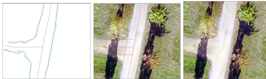
Рисунок 4.20 – Векторизация полевой дороги: а) автоматизированное создание средней линии дорог, б) параллельный перенос средней линии на расстояние половины ширины дороги, в) скругление и редактирование контура дорог
