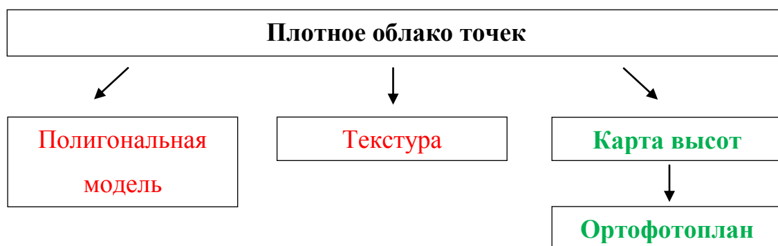
Рисунок 3.4 – Порядок создания полигональной модели, текстуры, карты высот и ортофотоплана на основе плотного облака точек. Зеленым выделены объекты, необходимые для создания топографического плана
