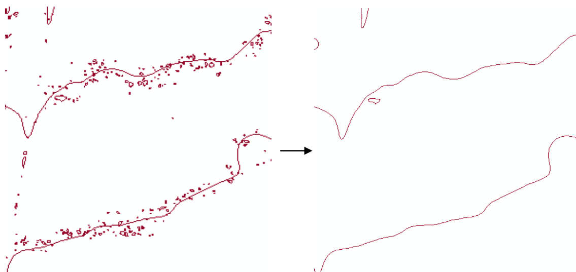
Рисунок 3.9 – Пример удаления горизонталей небольшого размера
