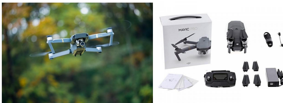
Рисунок 1.7 – БЛА DJI Mavic Pro (слева – в полете, справа – БЛА и его комплектующие)
