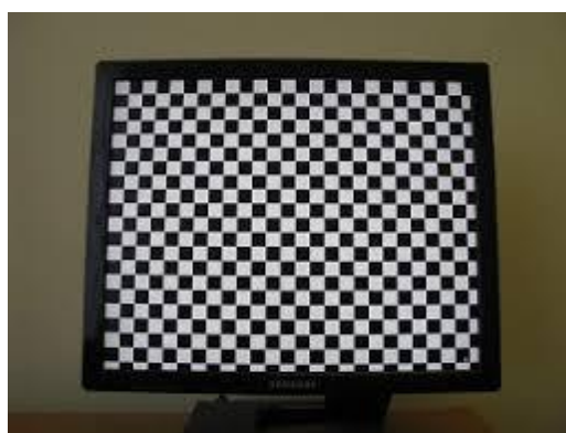
Рисунок 3.3 – Калибровочный объект в виде шахматной доски
