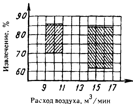
Рис. 6.19. Извлечение молибдена в цикле основной коллективной флотации во флотомашине ФП-80 с различными азэраторами: штриховка - газифицированный азэратор; вертикальные линии - нижний кольцевой и горизонтальные линии - верхний трубчатый азэраторы
