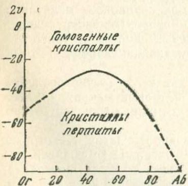
Рис. 47. Распределение гомогенных и пертитовых калинатовых полевых шпатов в зависимости от состава и угла оптических осей (по А. С. Марфунину)
