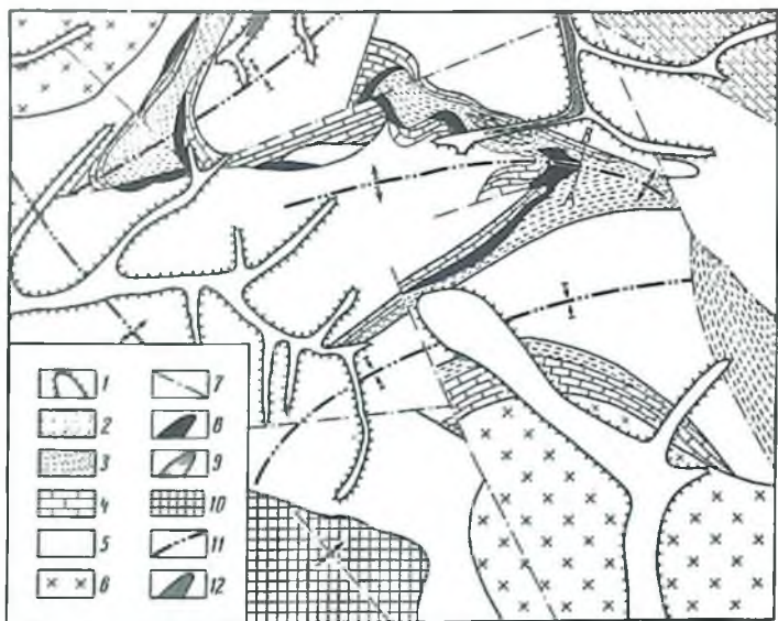
Р и с . 13. Схема геологического строения вторичного золоторудного месторождения, развитого по крупным малосульфидным минерализованным зонам дробления (по В. А. Лопатину с дополнением автора)
