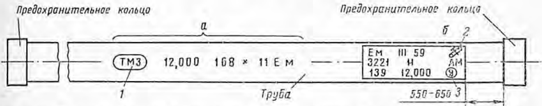
Рис. 86. Пример маркировки бурильных труб из стали марки ЕМ Таганрогского металлургического завода.
