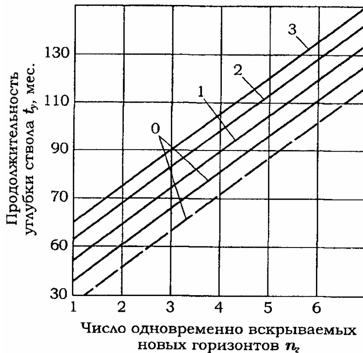
Рис. 3.16. График продолжительности углубки ствола в зависимости от числа одновременно вскрываемых новых горизонтов: 0, 1, 2, 3 - число пластов, вскрываемых стволом
