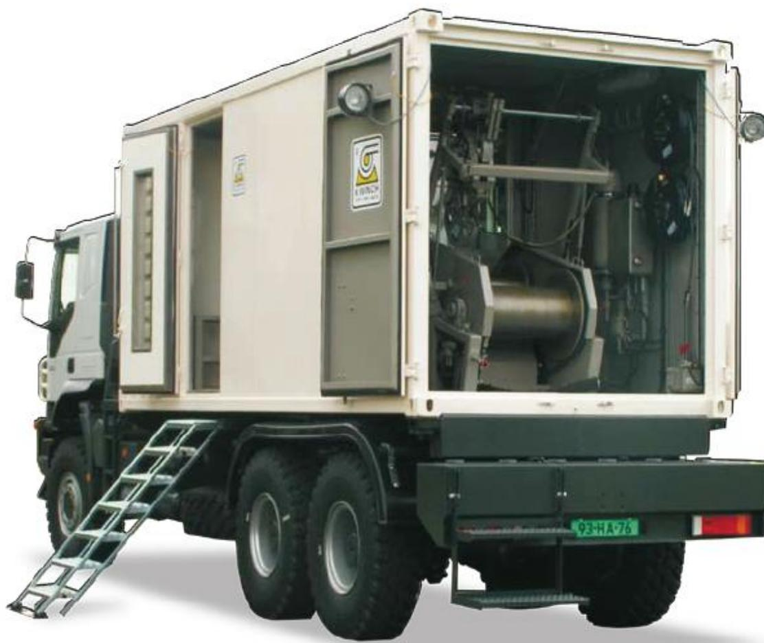
Рисунок 2.7 – Общий вид установки «Land Line D» на грузовом шасси
