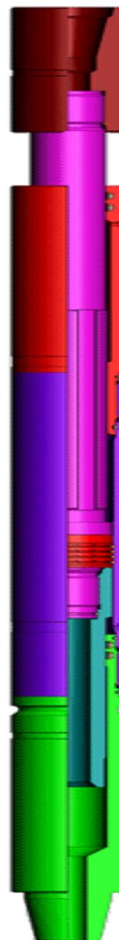
Рисунок 5.12 – Яс гидравлический
