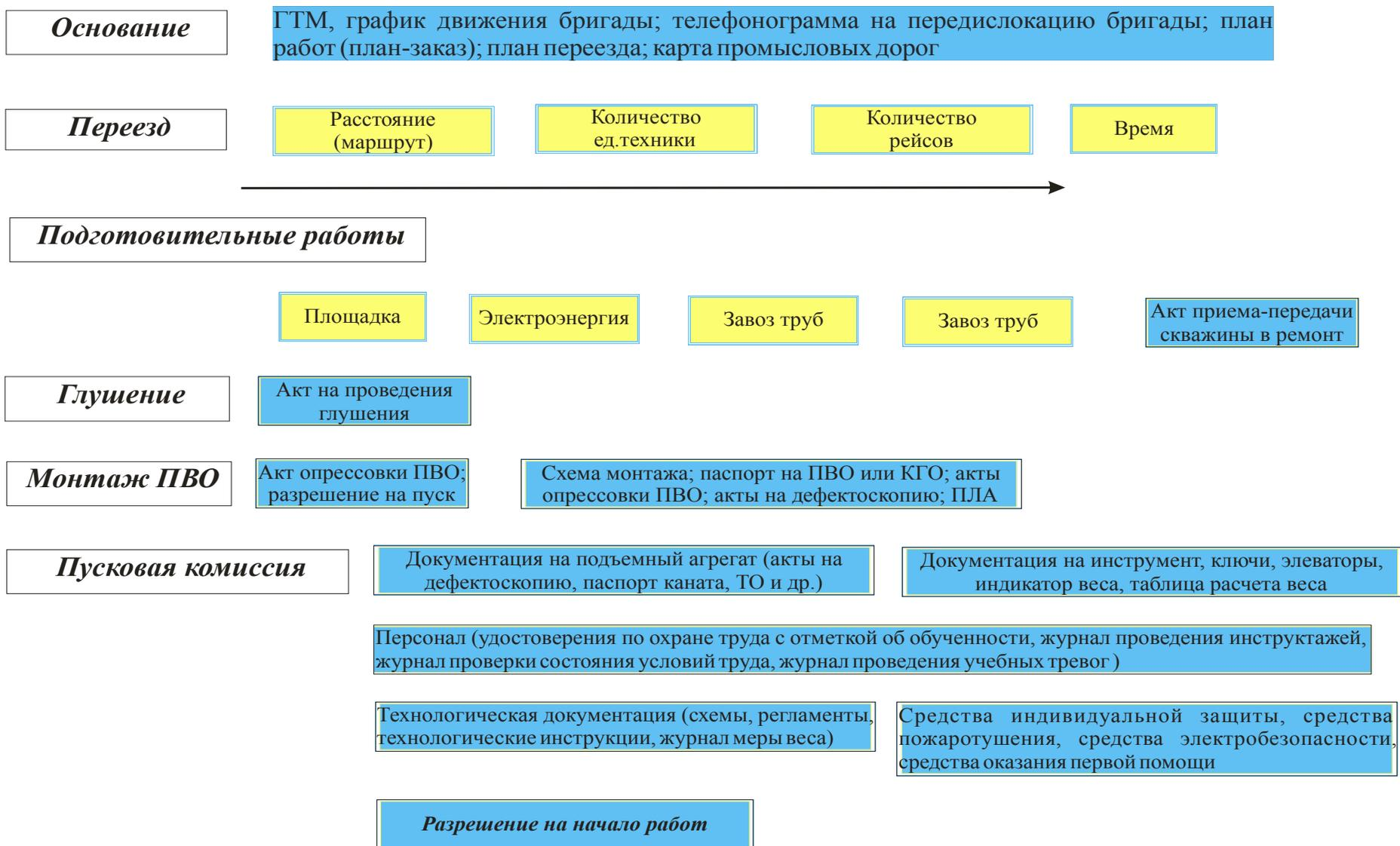
Рисунок 2.8 – Схема последовательности действий при переезде бригады ТКРС
