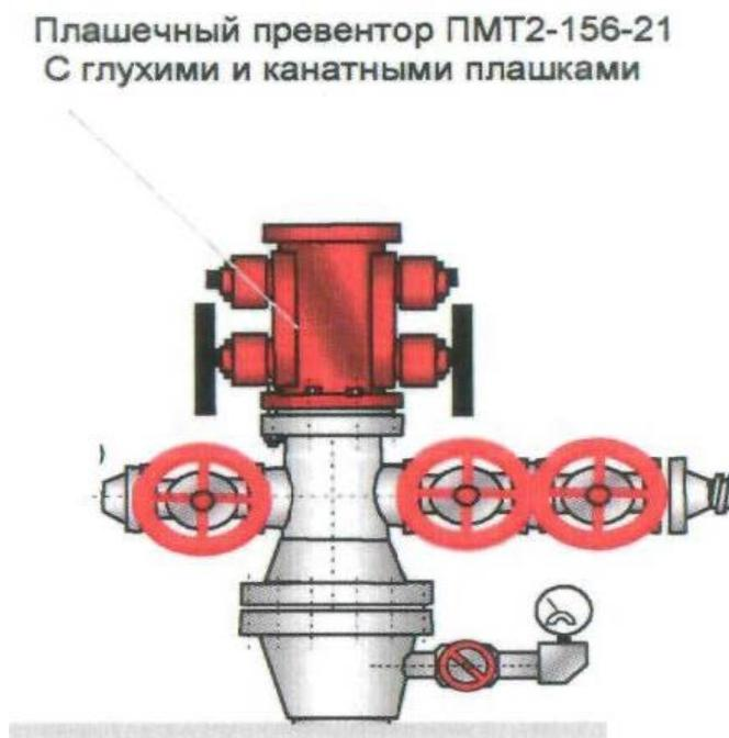
Рисунок 3.8 – Схема монтажа ПВО при перфорации или свабировании
