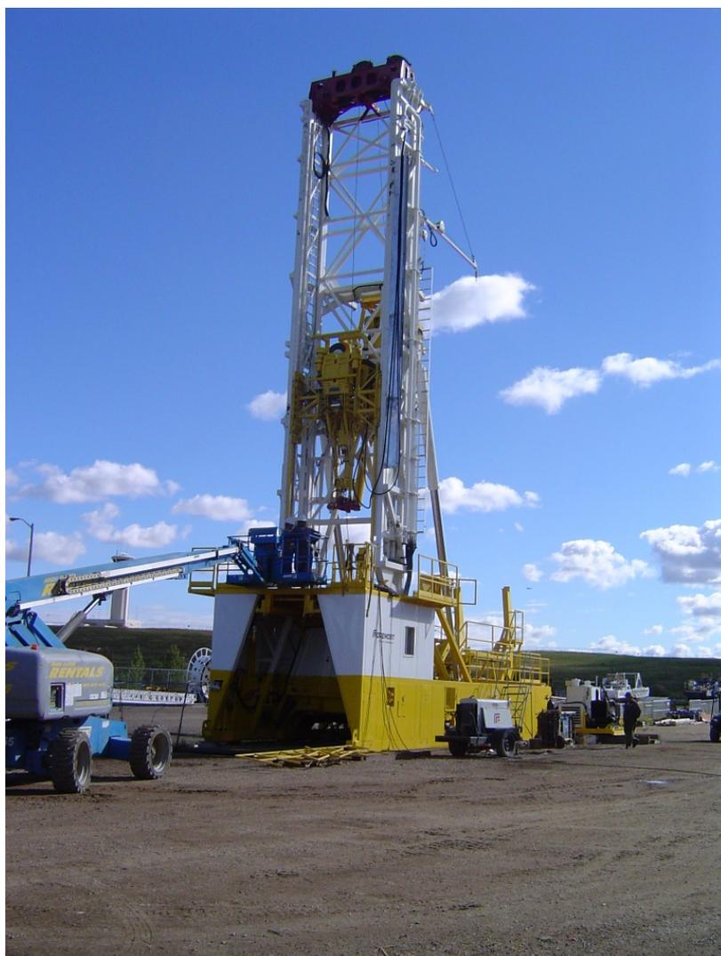
Рисунок 2.6 – Общий вид гибридной установки Foremost CTR80/100
