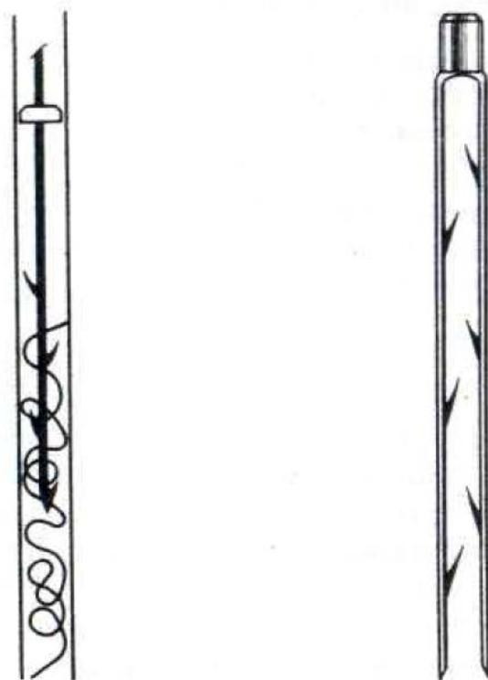
Рисунок 5.52 – Инструмент для извлечения оборванного кабеля:
