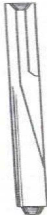
Рисунок 5.16 – Переводник с боковым отверстием
