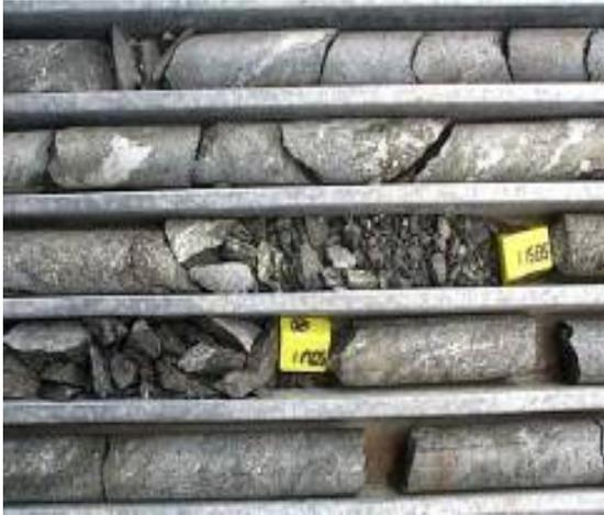
**Рисунок 4-2: Сильное повреждение керна**
