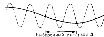
Рис. 4.57. Высокоэнергетическая синусоидальная волна (прерывистая линия), наблюдаемая в дискретном множестве точек, дает отчетливо видную волну низкой частоты (сплошная линия)
