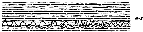
Рис. 15. Запись поверхностной волны Релея с наложением обертона.
