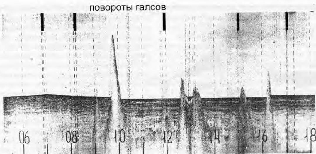
Рис. 5.13. Строение осадочного чехла в западной части разлома Долдрамс по данным НСП (Строение..., 1991). 1–3 – сейсмические разрезы: 1 – вдоль 44^{\circ}00' ; 2 – вдоль 44^{\circ}15' з.д. (север справа); 3 – вдоль 44^{\circ}30' з.д.
